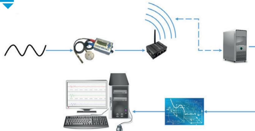
Des instruments nommés « sismographes » mesurent les vibrations en continu et collectent des données. Ces instruments sont sous la responsabilité d'un consultant externe au complexe minier LaRonde. Les sismographes sont composés d'un géophone connecté à un système d'acquisition de données. Un modem cellulaire fait la connexion entre le sismographe et le serveur central du fournisseur externe. Un module d'analyse traite les mesures et les archives sur un site web sécurisé.
