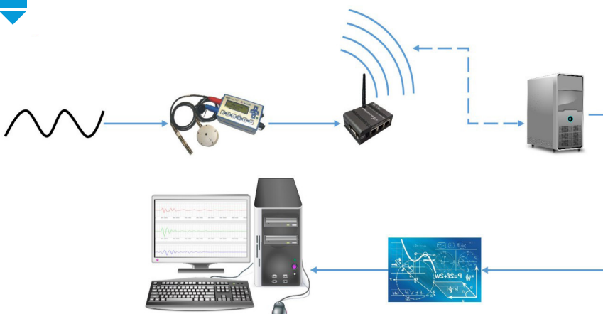
FIGURE 6 : DESCRIPTION DU SYSTÈME DE MESURE DES VIBRATIONS
