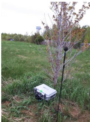
**FIGURE 1:** EXEMPLE DE STATION DE MESURES ENVIRONNEMENTALE UTILISÉE DANS LE CADRE DE L'ÉTUDE DE CONFORMITÉ SONORE.
