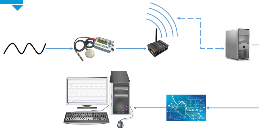
FIGURE 6 : DESCRIPTION DU SYSTÈME DE MESURE DES VIBRATIONS
